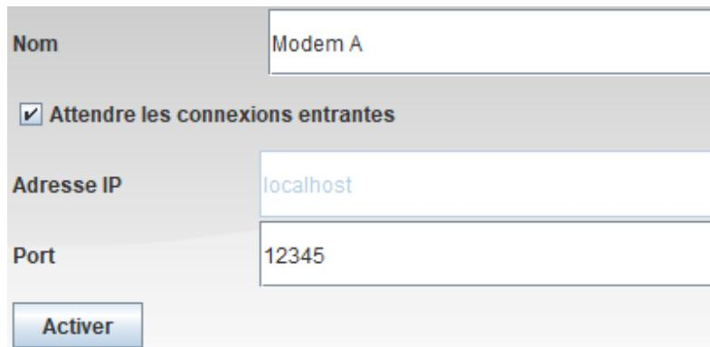
L'autre modem d'un autre réseau virtuel peut désormais établir une connexion réseau physique, en utilisant l'adresse *IP* du modem récepteur (adresse *IP* physique du premier ordinateur). Les deux modems indiqueront une connexion réussie par un petit point vert.
