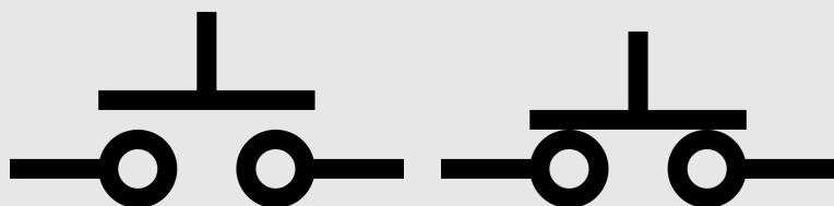
Le bouton du mBot est un bouton NO, car, lorsque l'on appuie dessus, on obtient un signal électrique (état haut), alors qu'au repos on n'obtient pas de signal (état bas).
