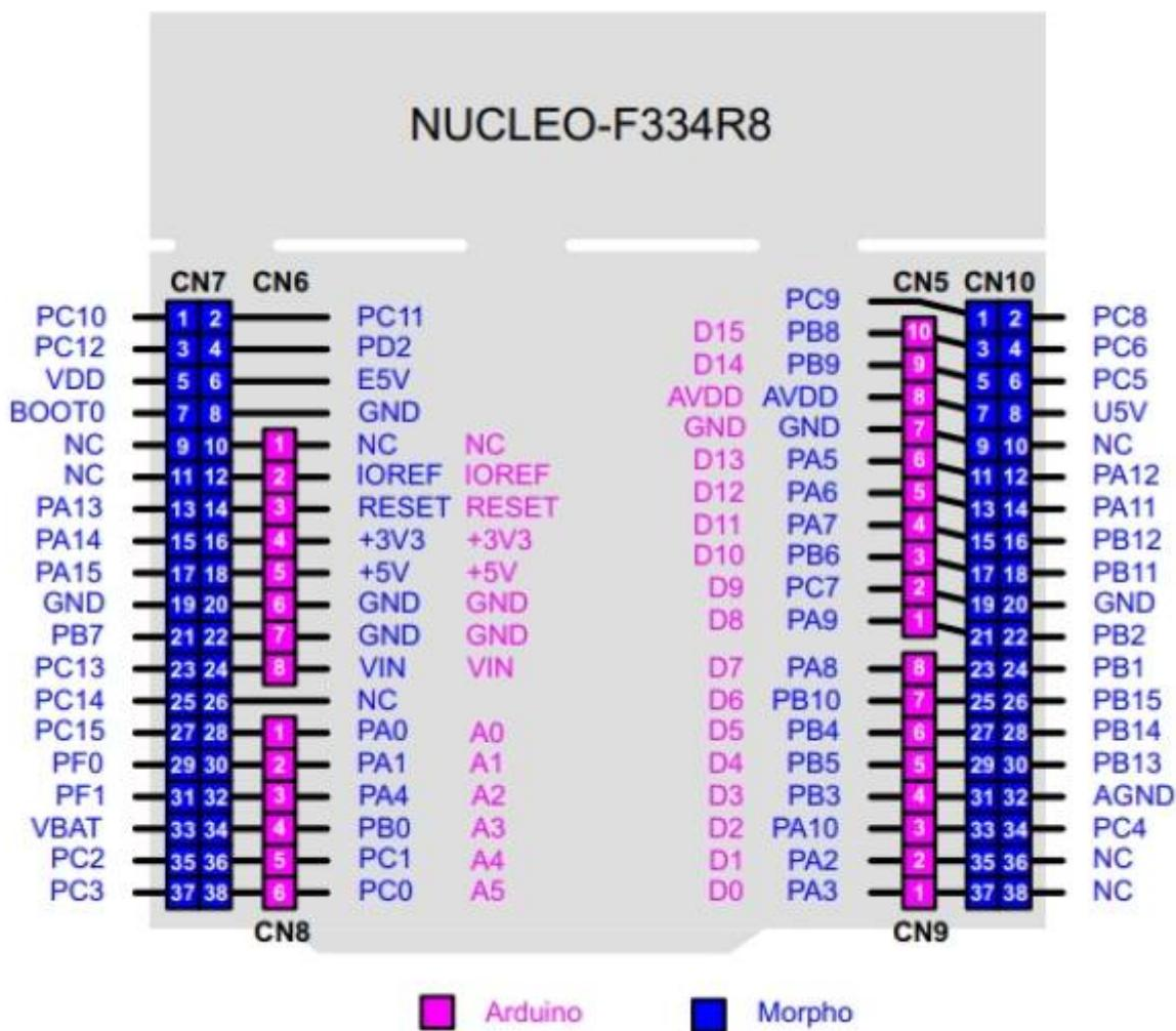
Pour piloter la led intégrée qui est connue comme "D13" sur Arduino, il faut sur la carte STM32334R8, piloter la sortie "PA5", ou "PA\_5" comme illustré dans le tableau de correspondance ci-dessous :
