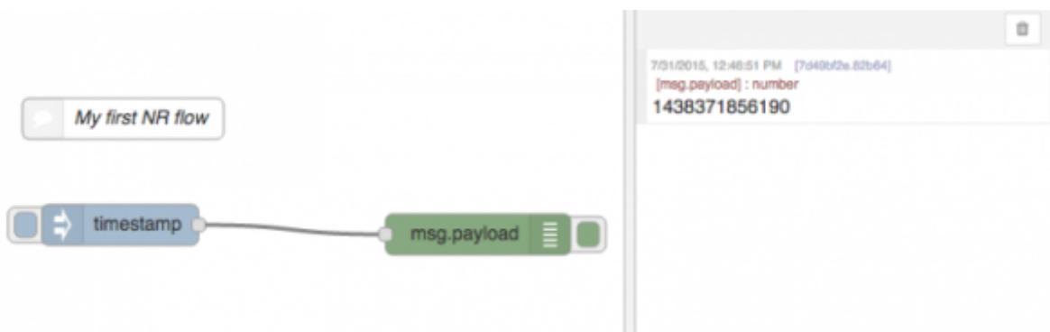
Figure 2.7 Sortie de débogage de votre premier flux - l'heure à laquelle vous avez cliqué sur le nœud d'injection.
