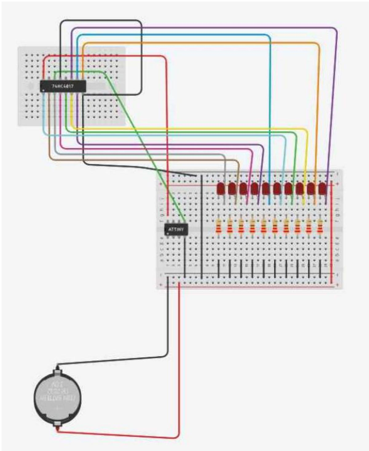
Ce montage utilise un 74HC4017 commandé par un Attiny ( petit arduino) , un Arduino Uno aurait fait l'affaire, 10 leds et 10 resistances 220 Ohms et une pile bouton CR2032 3V
