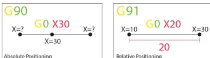
Les commandes G90 et G91 indiquent à la machine comment interpréter les coordonnées utilisées pour le mouvement. G90 établit le "positionnement absolu", qui est généralement la valeur par défaut, tandis que G91 est pour le "positionnement relatif". Aucune des deux commandes ne nécessite de paramètres, et la définition de l'une annule automatiquement l'autre.
