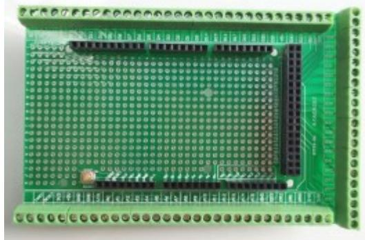
Sheild raccordement à vis arduino Méga
