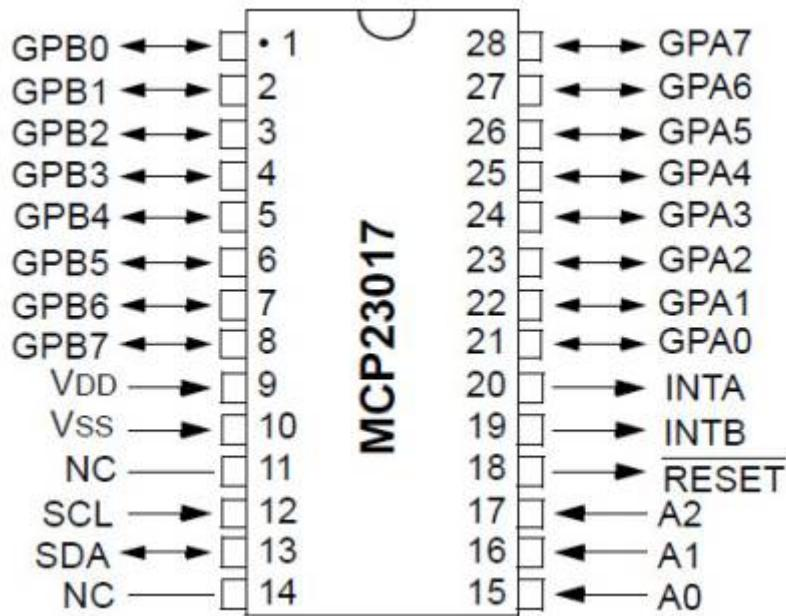
[MCP23017 16 entrées/sorties sur un arduino](#)
