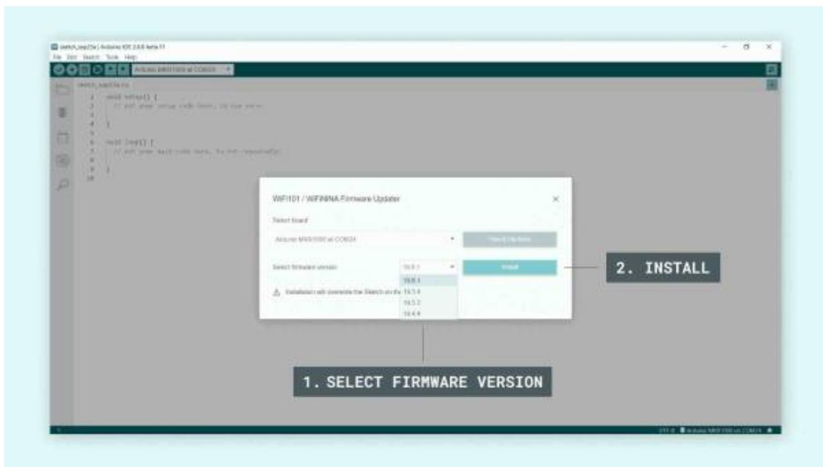
Vous pouvez mettre à niveau et rétrograder la version du micrologiciel de vos cartes Wi-Fi (avec un module NINA) et télécharger des certificats racine SSL directement dans l'IDE.
