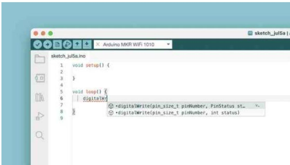
La saisie semi-automatique est un must pour les éditeurs de code, et la version 2.0 est bien équipée. Lors de l'écriture de code, cela est utile pour mieux comprendre les éléments de l'API Arduino.
