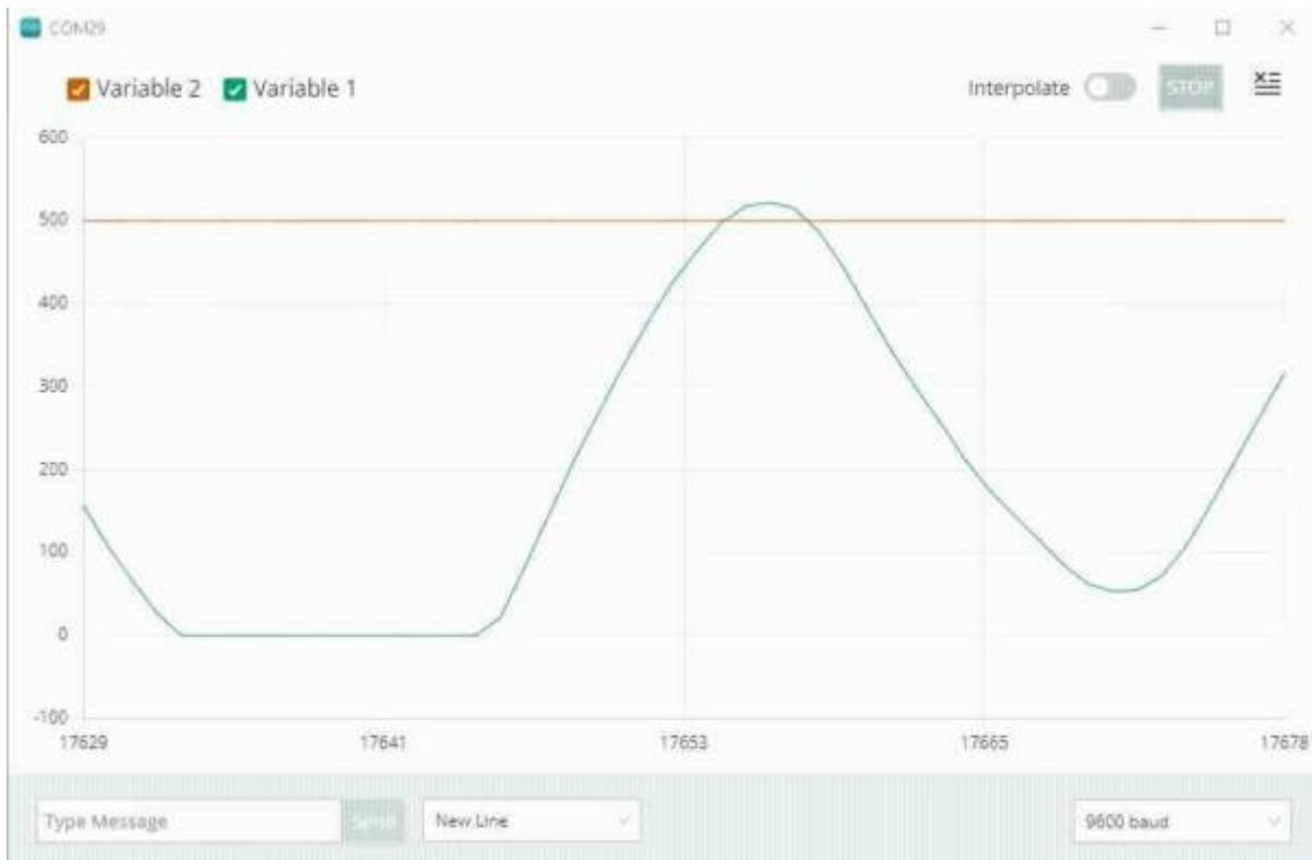
L'outil Serial Plotter est idéal pour visualiser les données à l'aide de graphiques et pour surveiller, par exemple, les pics de tension.
