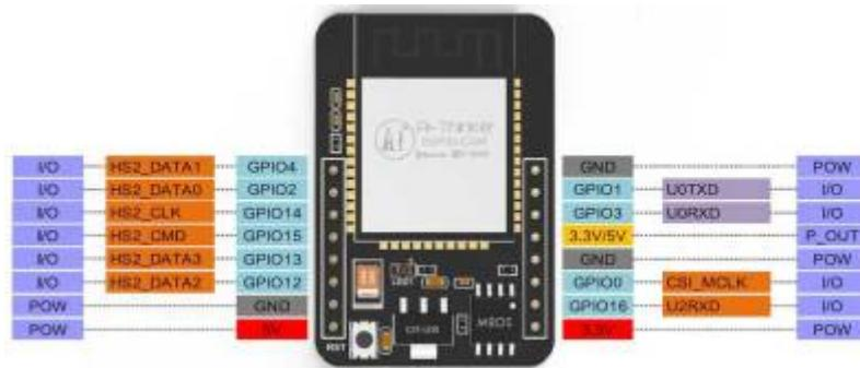
**Le raccordement des broches TX et RX , doit être vérifié , le schéma indique un branchement croisé entre l'ESP-Cam et USB-Série ce qui veut dire : TX ESP (GPIO1) sur RX série et RX ESP (GPIO3) sur TX Série**
