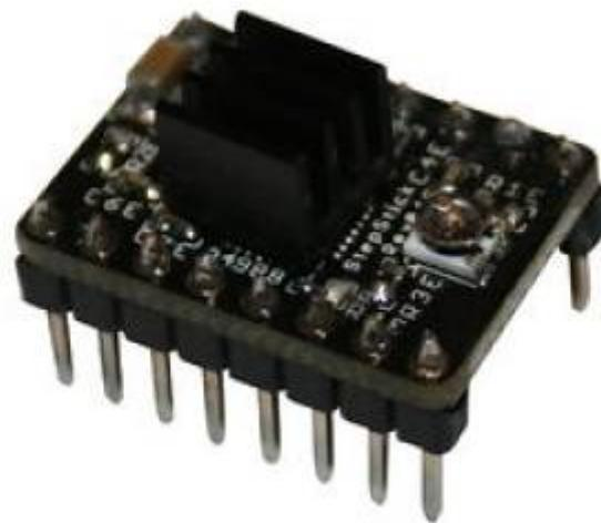
Ce contrôleur permet de contrôler des [moteurs pas-à-pas bipolaires](#) en micro-stepping avec un maximum de 2 ampères par bobine (attention aux conditions de dissipation de chaleur!!!).
